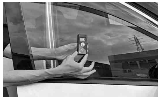
可視光線透過率は目視判定も容認されているが、ほぼ透明なフィルムでも装着するガラスによっては保安基準を下回るため、測定器による計測が不可欠だ。
